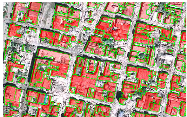
Detección de edificios en Puerto Príncipe, Haití, mediante el análisis de puntos LiDAR, tras el terremoto de 2010. Forma parte del proyecto de investigación de la Tesis Doctoral.
