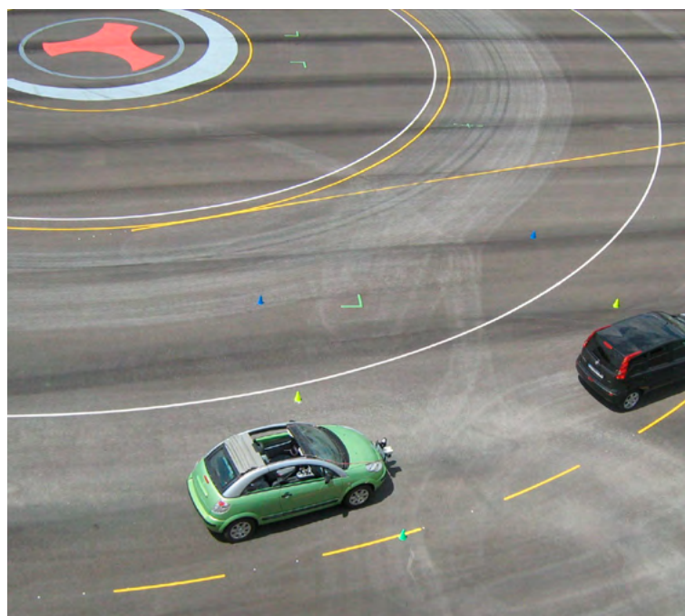
Ensayos de detección de obstáculos para maniobras evasivas automáticas.
