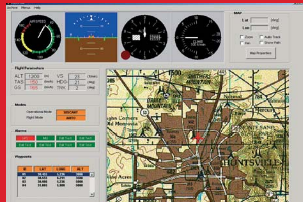
Interfaz gráfica AP-04 con HW COTS del Sistema SISCANT.
