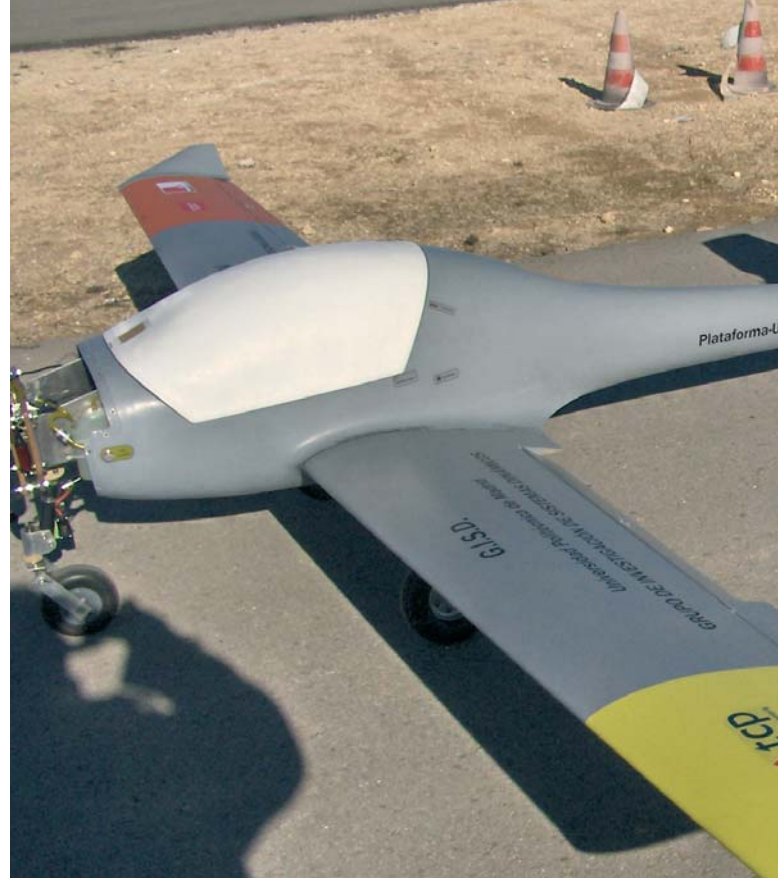
El KUAV-1 es un modelo a escala 1:3 del Katana Superdimona.
